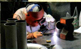
工場の排気ガス処理設備の配管部品を溶接。板金や折り曲げ機械も自社で持ち、顧客の要望に応える。
