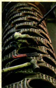
自動車やコンクリート材をも砕く巨大破砕機のブレード。鋼鉄でコーティングし強度を高める。
