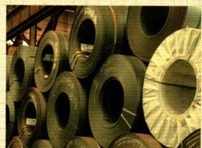
1つのコイルは5~30トン。巻き癖のあるコイルを、ローラーに3回かけてフラットにしていく。
