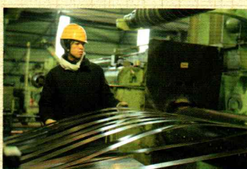
板厚の厚いコイルを切断できるのは、関西でも数社のみ。12mmまでの厚みを切ることができる。
