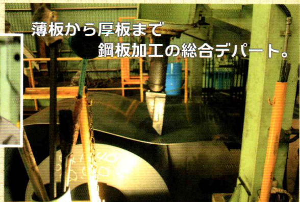
1つのコイルは5~30トン。巻き癖のあるコイルを、ローラーに3回かけてフラットにしていく。
