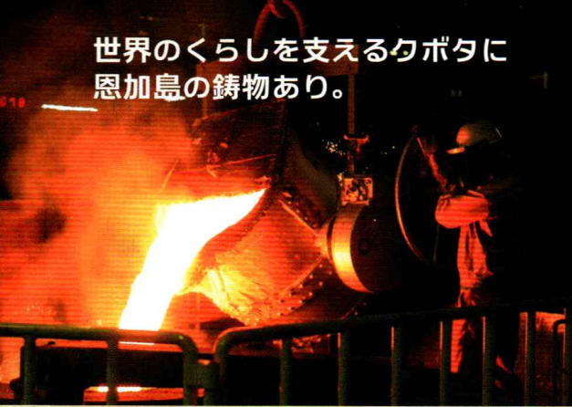
「湯」とも呼ばれる3トンの溶かした鉄が取鍋(とりべ)で運ばれる現場は大迫力。溶湯の温度は1,400度以上!
